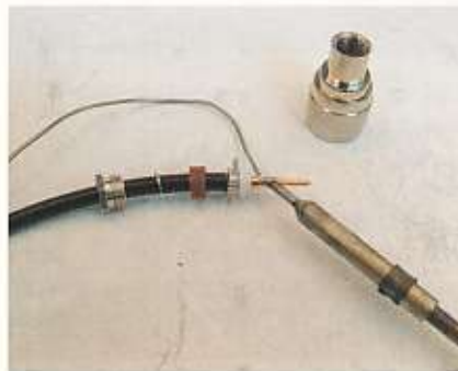
Solderen van het middencontact van de male-N.
